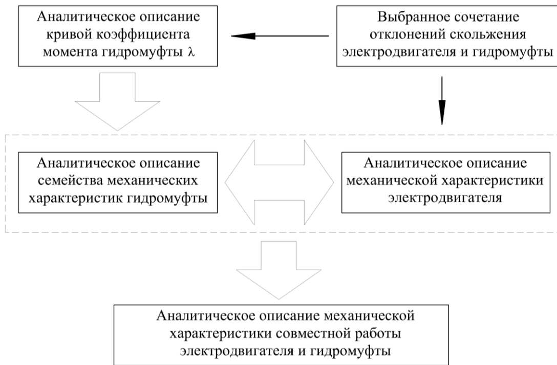
Рисунок 3 – Структурная схема математической модели совместной работы электродвигателей и гидромуфт
