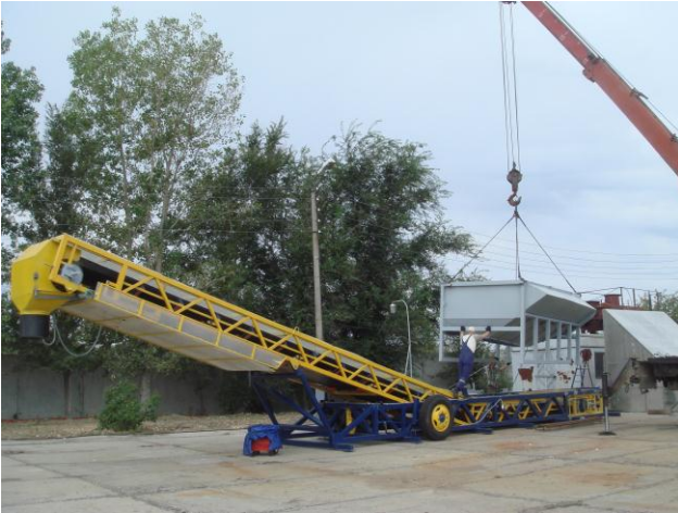
Рисунок 4 – Приемный ленточный передвижной бункер-питатель СПКБ 12-4
